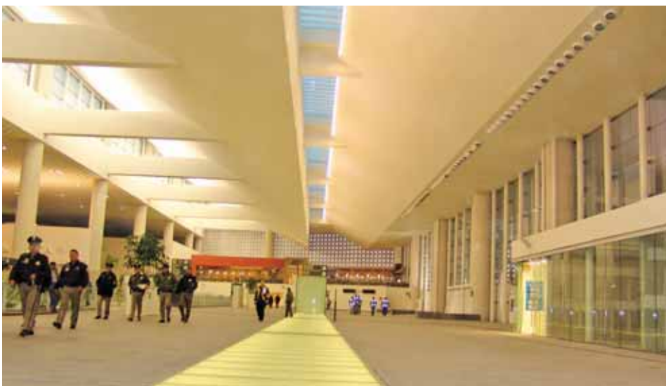
La Terminal 2, está diseñada de tal forma que no se necesita luz eléctrica, su iluminación es natural, tanto en la parte de arriba como en la de abajo; si hay lámparas, como un apoyo, pero es mínima la utilización.
